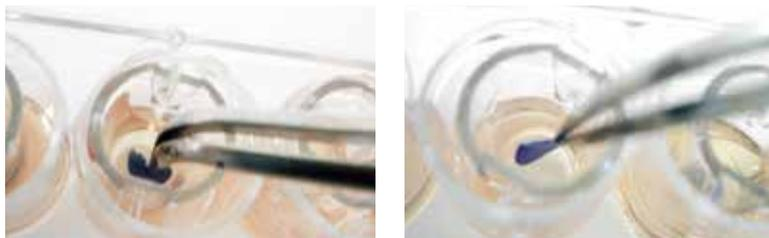
**Point** 評価物質によって皮膚組織構造が壊れてピンセットでつまめない場合、スパテルなどを用いて皮膚組織をかき集める、又は培養カップ底面のメンブランフィルターごとメスなどで切り取ってください。
