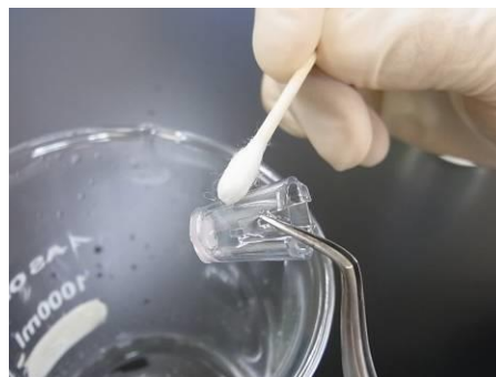
【写真5】 リン酸緩衝液の除去
